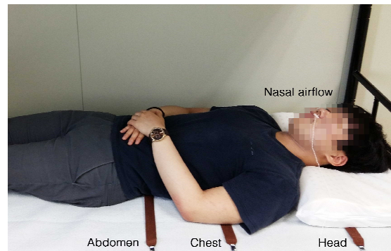
<그림 2> 스트립 힘센서 및 기준호흡센서(TDS202A) 배치
