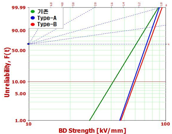
<그림 3> 와이블 분포함수를 이용한 AC특성평가의 통계적 분석
