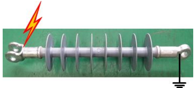
<그림 2> 섬락거리가 500 mm 이하인 시험품
