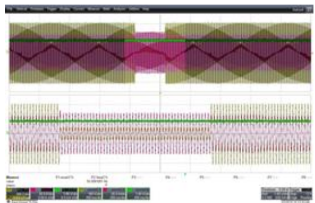
<그림 2> 순시 전압 저하(FRT)시험
