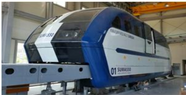
<그림 3> LSM 기반 초고속 자기부상열차
