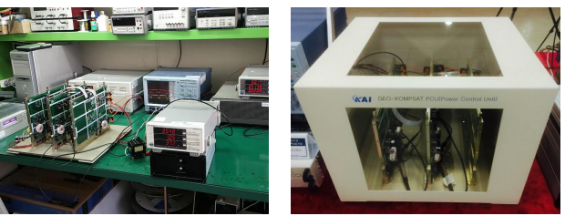
(a)시제품 실험 환경 (b)시제품 전시 사진 <그림 8> PCU 실험 환경 및 시제품 사진
