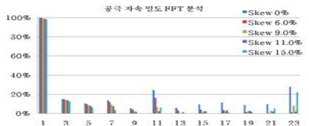
<그림 2.7> Skew 적용 시 공극 자속 밀도 FFT 분석
