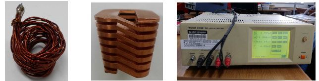
〈그림 6〉 Two types of coil and LCR meter
