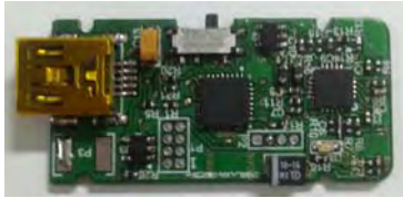
(그림 3) 제작된 심장활동 측정 모듈
