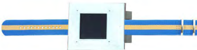
그림 1 선형 위치 센서를 이용한 간접적 인터페이스를 적용한 프로토타입
