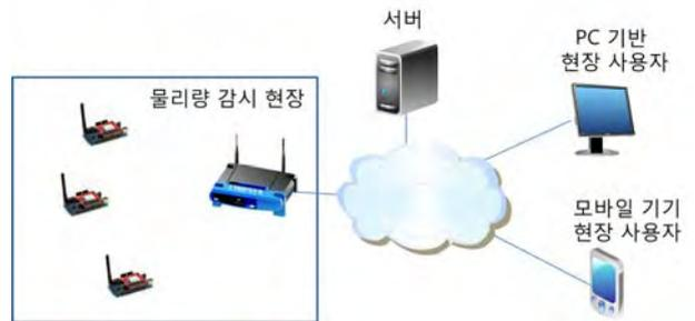
[그림 3] IoT 센서 데이터 감시 시스템 구조
