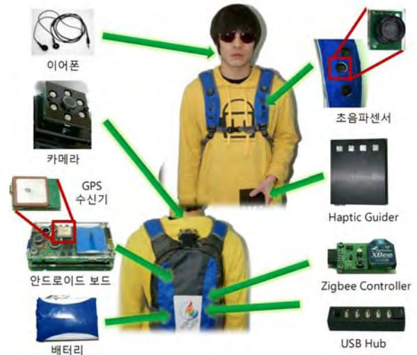
(그림 1) 시각장애인을 위한 보행안내 시스템 시제품
