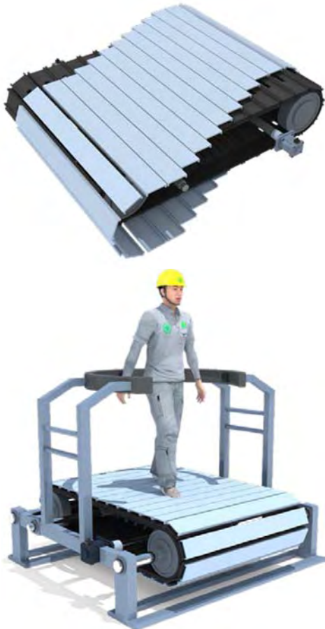
(그림 2) 좌우 선회보행이 가능한 트레드밀 장치
