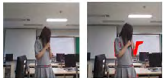
(그림 9) 팔을 움직일 때 프레임의 색상 정보 차이를 표시
