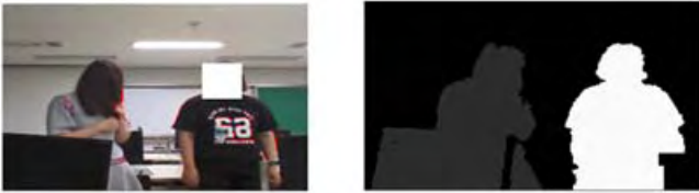
(그림 6) 키넥트 센서의 컬러 영상(좌) 및 깊이 영상(우)
