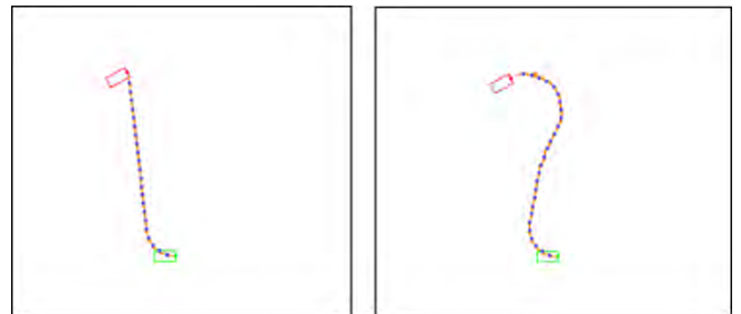
[그림 3] Euclidean 거리 heuristic 함수 기반(좌), euclidean 거리와 방향각 차이가 결합된 heuristic 함수 기반(우) A* 경로 계획.
