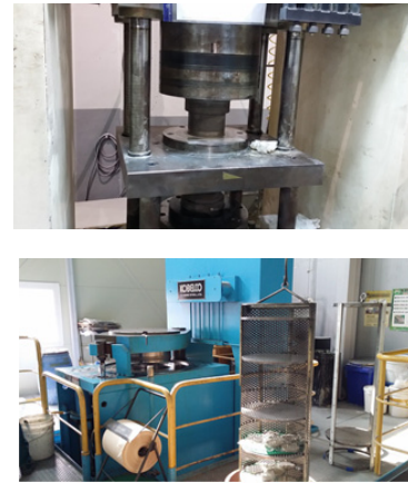
Fig. 1. 200ton press & CIP apparatus.
