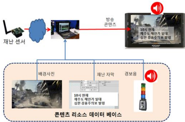
그림 7 재난유형별 자동 콘텐츠(사진,음성,자막) 추출부
