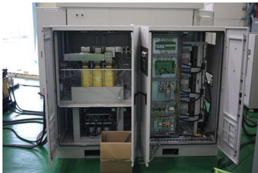
그림3 성능 시험용 수랭식IGBT Stack 모습 외형
