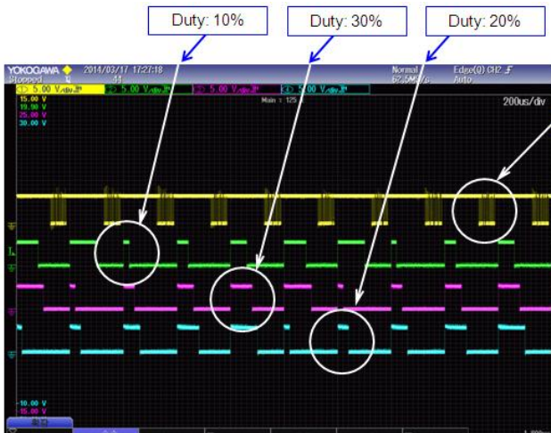
그림 2 스마트 전력모듈 데이터 교환 Fig. 2 Data exchanging of smart power module
