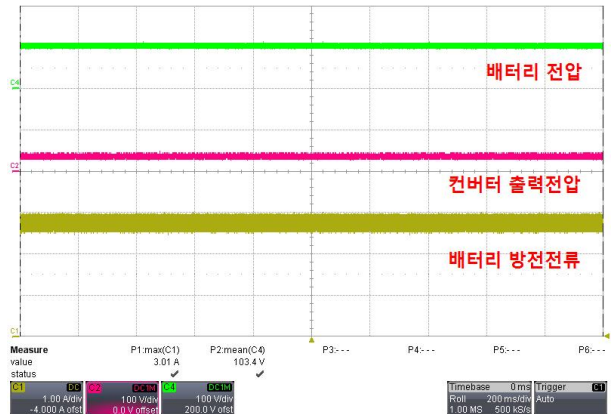
그림 4 BMS를 이용한 플로우배터리 방전 시 배터리 전압, 컨버터 출력전압 및 배터리 방전전류 Fig. 4 Battery Voltage, Converter Output Voltage and Battery Discharging Current When Flow Battery is Discharging Driven by BMS
