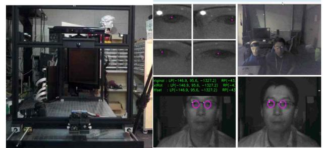
그림 3. 시스템 구성 및 동공 추적 결과
