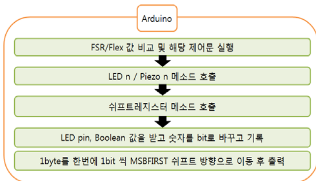
(그림 16) FSR/Flex에서 Arduino UNO로 받고 LED, Piezo로 보내는 Software Architecture(2)
