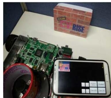
(그림 4) 임베디드 보드내의 카메라와 스마트폰의 통신을 이용한 원격영상 획득 과정
