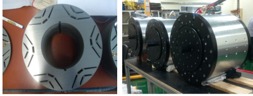
(a) 회전자 코어 형상 (b) 제작 완료된 전동기 그림 4 Medium Duty용 전동기 설계도면 및 실제형상
