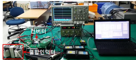
그림 5 결합 인덕터를 이용한 풍력/태양광용 컨버터 시험환경 Fig. 5 Test environment of wind turbine/photovoltaic converter using a coupled inductor
