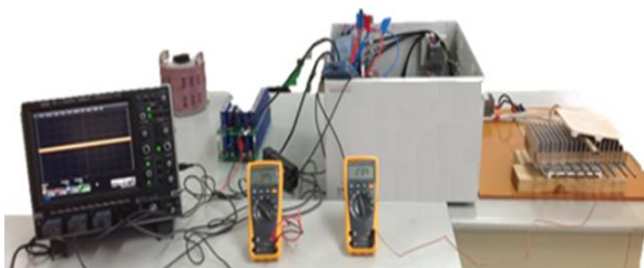
그림 3 순간전압강하 보상장치 Fig. 3 Dynamic Voltage Restorer
