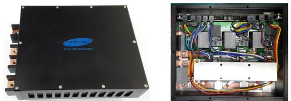
그림 6 ISG 시스템용 DC-DC 컨버터 시작품
