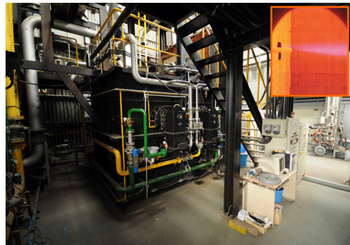
그림 3. 한국에너지기술원 내에 설치된 0.5 MW 파일럿 플랜트 급 순산소 연소로 사진 [2]
