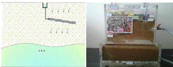
▶▶ 그림 3. 농어촌용 저류시설 구축공법의 개념 및 모형
