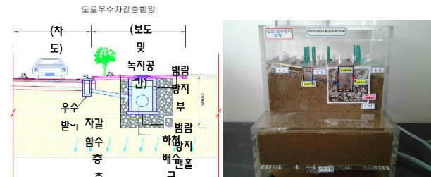
▶▶ 그림 4. 도심침수 방지용 저류시설 구축공법의 개념 및 모형[2]
