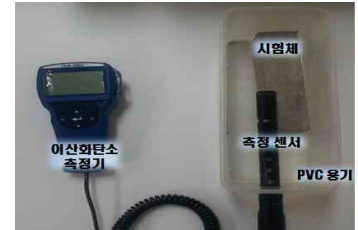
그림 1. 이산화탄소농도 측정 모습
