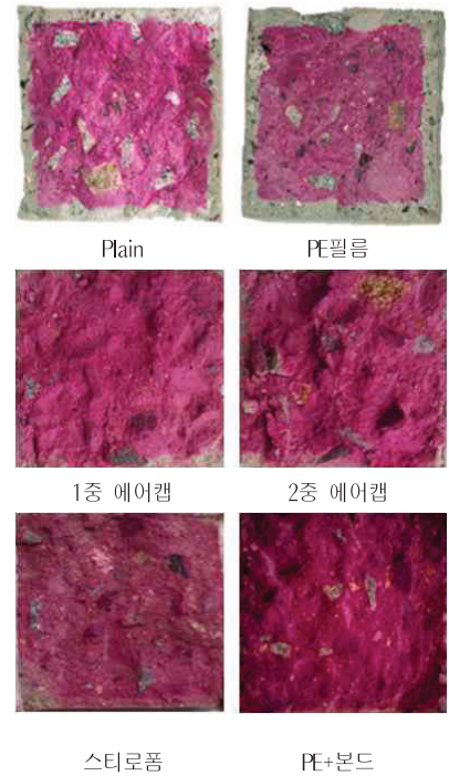
사진 1. 탄산화 촉진 실험결과 사진
