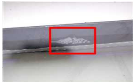
그림 4. Low Modulus 제품 부틸 단선발생
