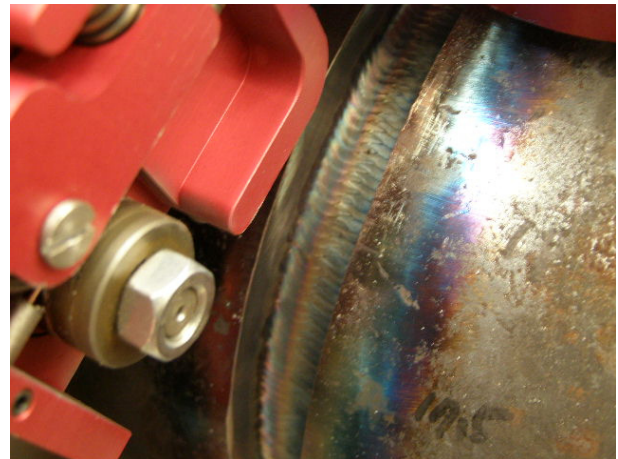
Fig. 17 위빙 폭 자동 제어 및 용접선 자동추적 결과
