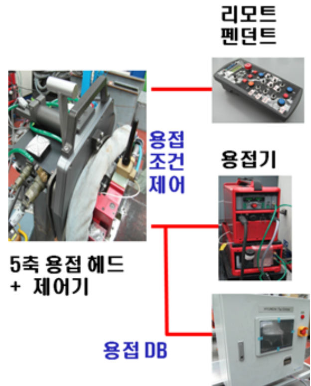
Fig. 7 배관 용접용 오비탈 자동 용접시스템 구성도
