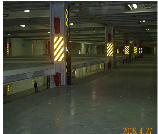
Fig. 3 실제 호선에 적용된 Liftable Car Deck
