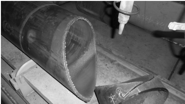
Fig. 19 1차 테스트의 최종 절단 결과
