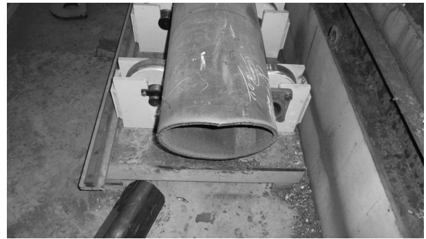
Fig. 20 Magnetic 롤러 및 절단 결과
