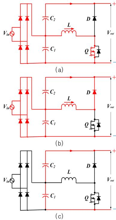
그림 2 동작모드, (a) 모드 1 (b) 모드 2 (c) 모드 3
