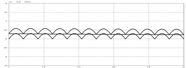
그림 4 커패시터의 양단전압 및 PFC단 출력 전압, ( $V_{C1}$ ,  $V_{C2}$ ,  $V_{out}$ )
