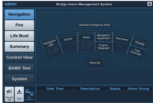
그림 4. 선교경보관리시스템 Navigation alarm UI
