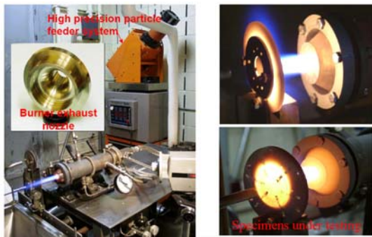
Fig. 16 Mach 0.3-1.0의 버너를 사용한 TBC의 내구성 시험[13]
