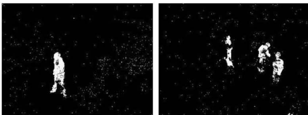
그림 2. GMM을 이용한 배경 분리 결과
