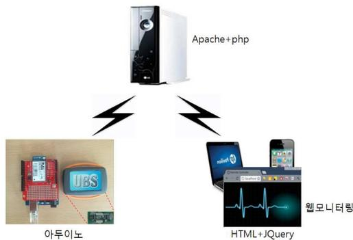
그림 2 구현된 무선 데이터 전송 모델
