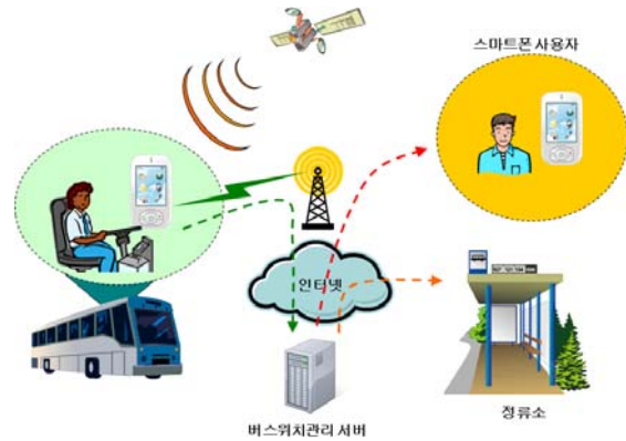
그림 5. 스마트폰을 활용한 BIS Fig. 2 BIS based on Smart-Phone
