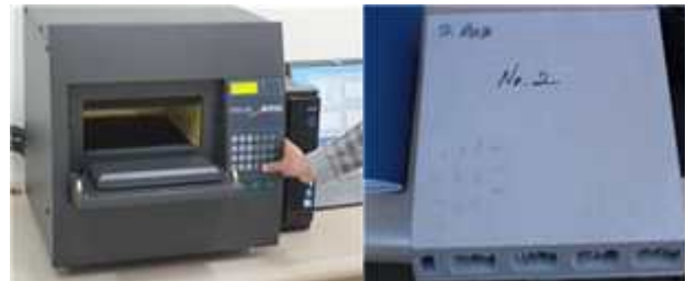
그림 2. 열전도율 시험기 및 시험편
