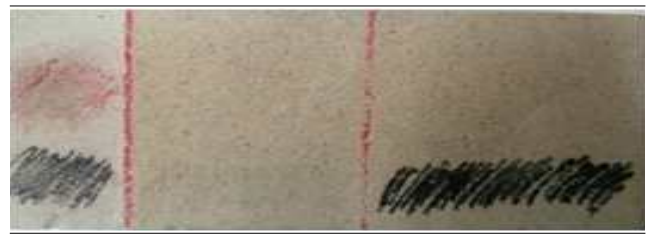
(d) 2차 도포면 크레파스 오염부위 물 세정 시험 후
