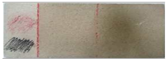
(e) 2차 도포면 유성매직 오염부위 물 세정 시험 후
