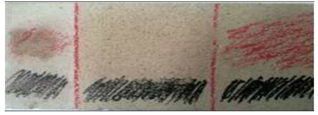
(b) 1차 도포면 크레파스 오염부위 물 세정 시험 후
