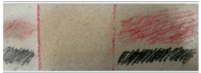
(c) 1차 도포면 유성매직 오염부위 물 세정 시험 후
