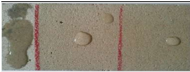
(a)내 흡수성 시험시작 표면 상태
