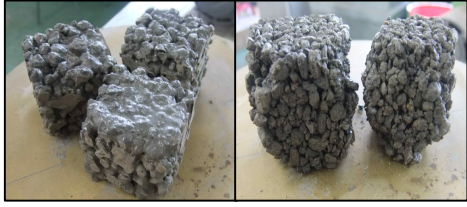
그림 2. 표면박힘이 발생한 깨짐 현상이 발생한 공시체
