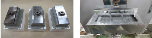
사진 2. 접착 모르타르 + 앵커 접착 시험체 및 접합 시험 현황
