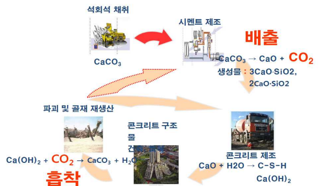
그림 1. 콘크리트 구조물의 CO 2 순환과정
