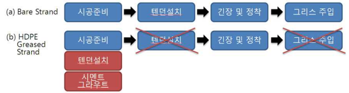
그림 4. 포스트텐셔닝 과정 및 개선된 절차
