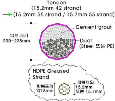
그림 3. 피복 스트랜드 텐던 조합 및 구성 형태
