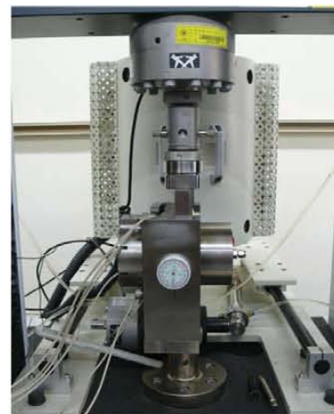
Fig. 1. 축소형(1/30 scale) 전단시험기기의 전단시험 모습.
