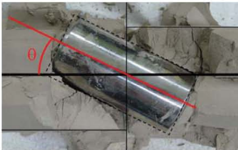
Fig. 3. 전단에 의한 부위별 센서의 압력변화 곡선(a)과 전단에 의한 소형 용기의 회전거동.
