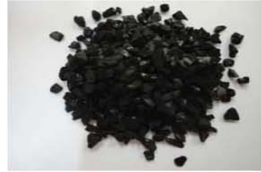
Fig. 1. 탈가스화 시험에 사용된 월성원전 공기정화계통 발생 폐활성탄 시료.
