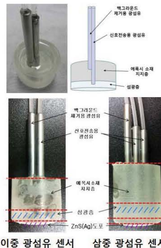
Fig. 1. 알파/베타선 오염도 원격 측정용 센서.
